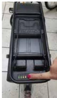
Sul lato sinistro c'è il pulsante di accensione della batteria (normalmente sempre attiva). In caso non sia attiva, è necessario posizionare il tasto su ON (led acceso) per avere la pedalata assistita.
